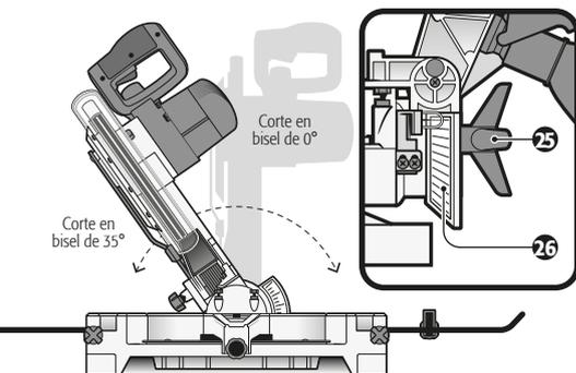
En el gráfico no se muestra la guía de corte para apreciar los topes del bisel.
